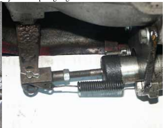
Fjäderbelastad stång på slavcylindern. TR Revington RTR1111.
