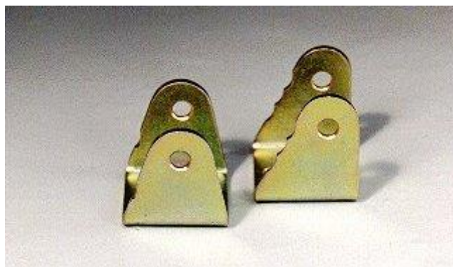
Bild på 141399 till vänster och 155502 till höger. 155502 har inte samma höjd som de två övriga vilket gör att denna inte bör användas på TR5, TR250 eller TR6 med de tidiga chassi-numren.
