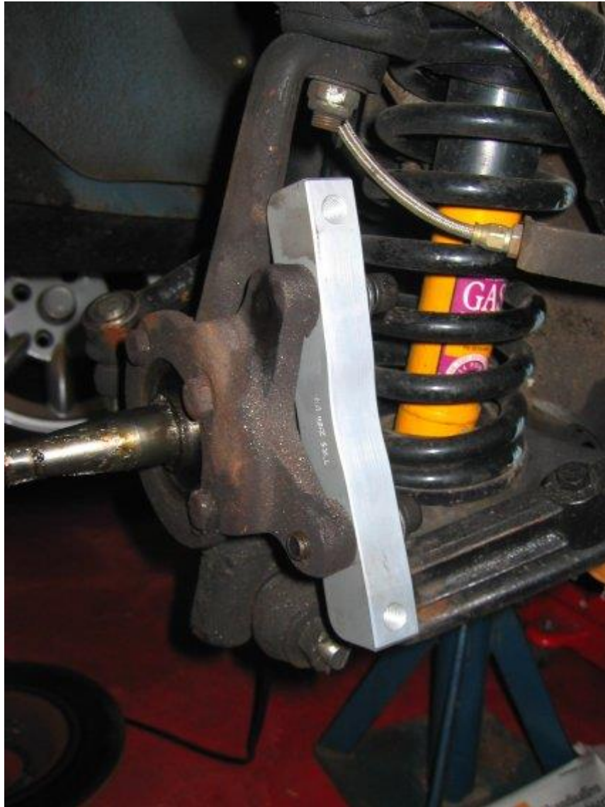
Al-adaptern monterad i befintliga hål.. På denna fästs sedan "Billet 4" bromsoket.
