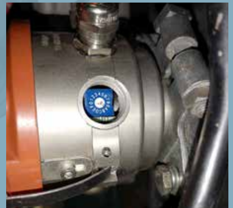
123 Ignition fördelare med omkopplare som möjliggör 16 olika tändkurvor.
