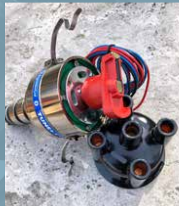
123 Ignition fördelare med programmerbara tändkurvor trådlöst via Bluetooth.
