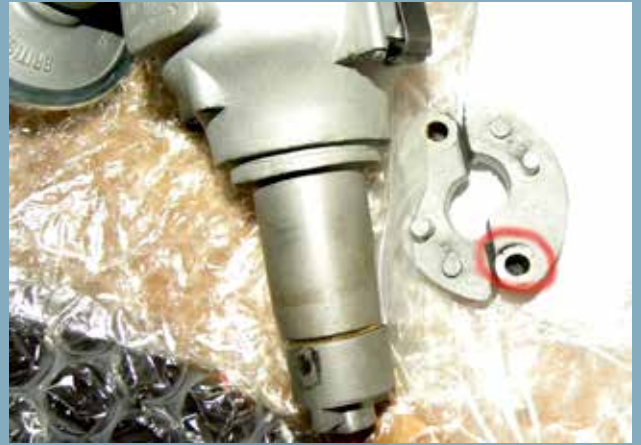
Axelhålen i balansvikterna kan slitas och tändkurvan blir därmed fel.
