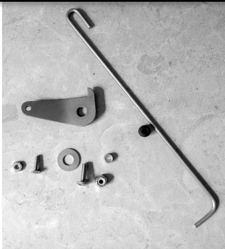
Alla delar som följer med. Det bifogas även en stoppskruv som förhindrar "spaken/kroken" att passera spärren när du drar i länkaget.
