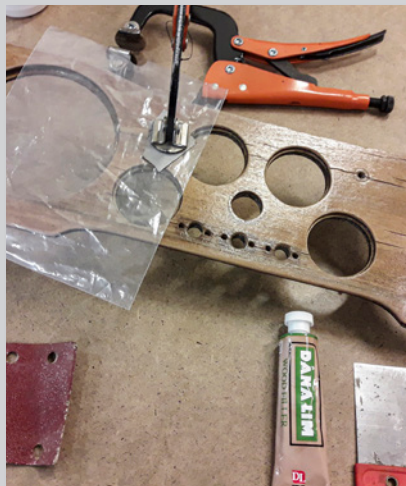
Limning av fanér i full gång. Plasten hindrar tvingen att fastna i limmet.
