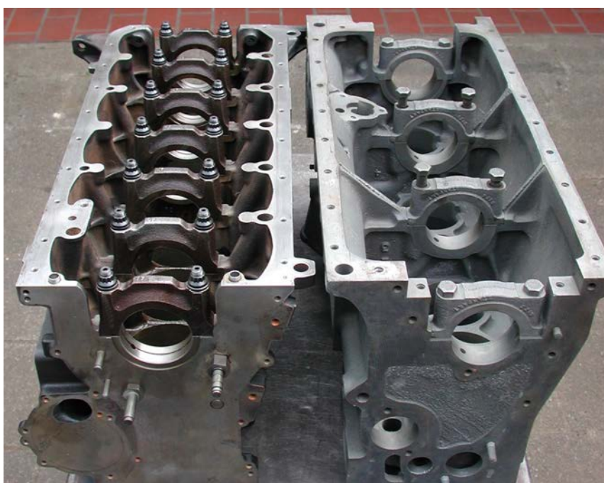
En modern rak 6-cyl motor från BMW med 7 vevstakslager till vänster och TR6-motorn till höger.
