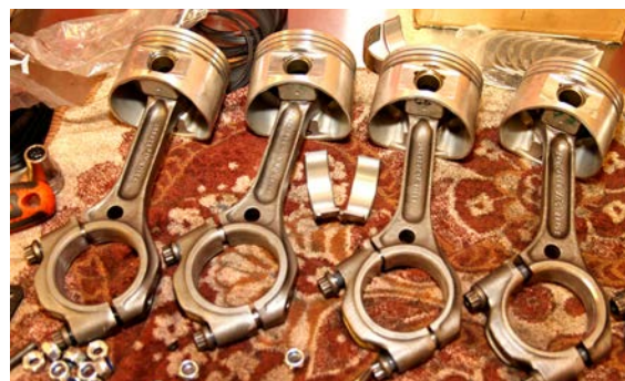
Bearbetad och lättad original vevstake med smidd kolv diam 77,5 mm. Original väger 1110 g. Detta väger tillsammans 945 g (15% mindre)
